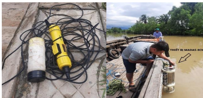
Hình 6. Thiết bị đo độ sâu (Hondex PS-7) và vận tốc (Midas-ECM).
